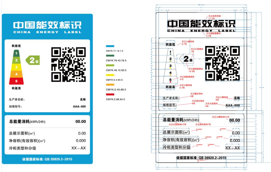
图 1 能源效率标识样式示例 (含总展示面积, 净容积单位为 m 3 )
